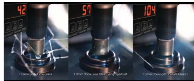
Pada Tes Tekanan, Corning® Gorilla® Glass 3 berhasil bertahan pada tekanan yang jauh lebih kuat dibandingkan dengan kedua kaca pesaingnya
